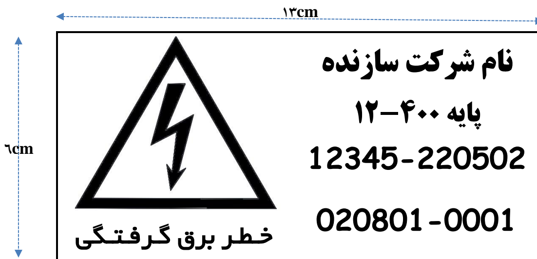
شکل (۱۷) - نمونه پلاک مشخصات پایه‌های کامپوزیت
